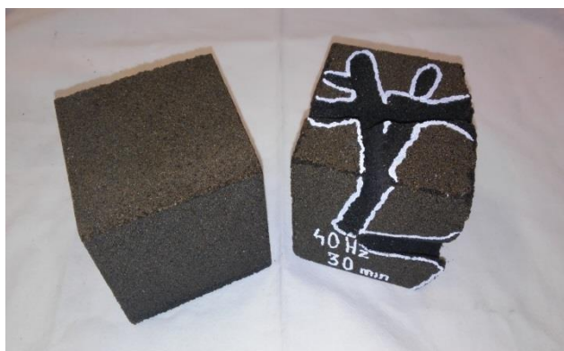
Rys. 2. Przykładowa kostka przed procesem (z lewej) i po procesie regeneracji wstępnej.
