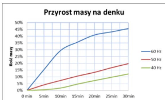
Rys. 4. Przyrost masy na denku zestawu do regeneracji wstępnej dla poszczególnych częstotliwości i czasów trwania procesu.
