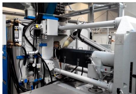
Rys. 4. Moment dozowania stopu przez piec systemu AVDF firmy Meltec
