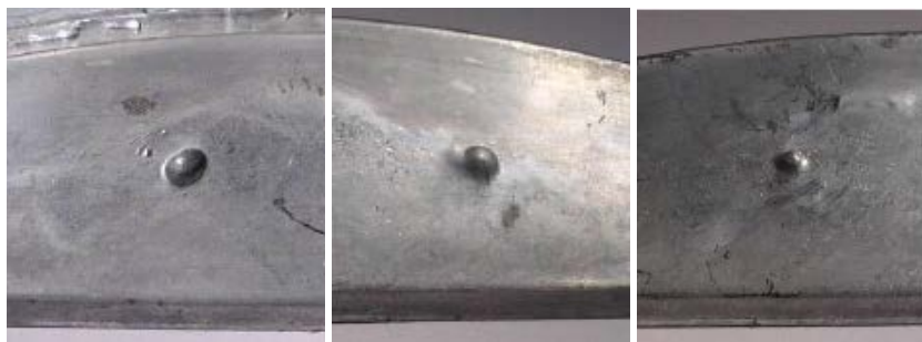
Rys. 1. Bąble na powierzchni cienkościennego odlewu ze żalu powstające w przypadku przedwczesnego otwarcia formy i wybicia odlewu
