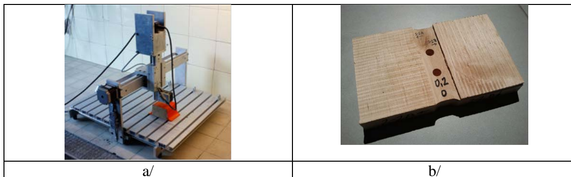
Rys. 1. Widok: a/ prototypowego laserowego profilometru; b/ próbki drewna olchowego po wstępnej obróbce mechanicznej przy pomocy maszyny CNC
